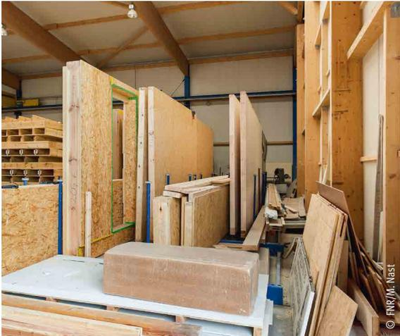
Holzbauelemente werden in Produktionshallen vorgefertigt ...
