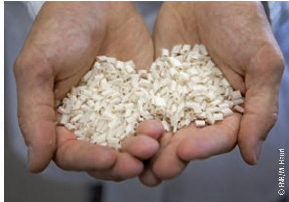
Mit einer Schicht Polylactid ummanteltes Zellulosefaser-Garn nach dem Schneiden
